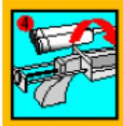
將植筋膠置入施工槍中開始施作
