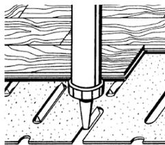
2. 使用手動槍或是氣動槍以包裝內附的三角切口膠嘴(寬 8 mm · 高 10 mm)將接著膠施打到所有的剪裁孔，施作時必須將剪裁孔完全填滿。
