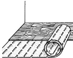
1. 將 SikaLayer 軟墊以與木地板材料長向平行的方式適當地鋪設在經過處理的基材上。
