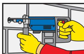
1. 用電鑽鑽孔至所需的直徑和深度。鑽孔直徑必須符合錨固尺寸
