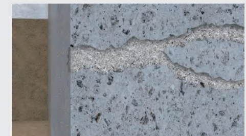
4. 在混凝土孔隙中形成不溶性晶體結構
